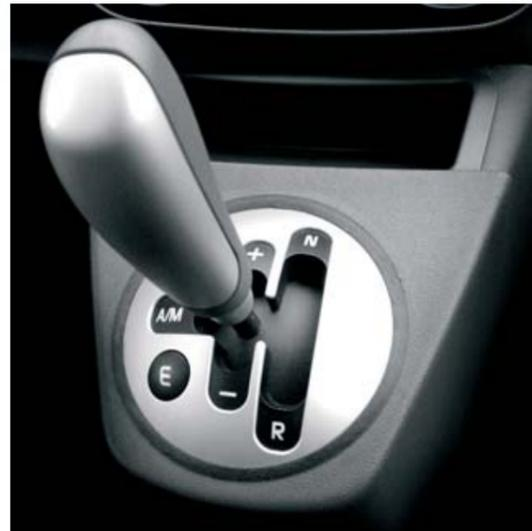
*La boîte de vitesses robotisée Comfort - Matic offre rapidité de passage et précision avec ses 5 rapports. Elle propose 3 modes de fonctionnement : automatique, économique et séquentiel.*
