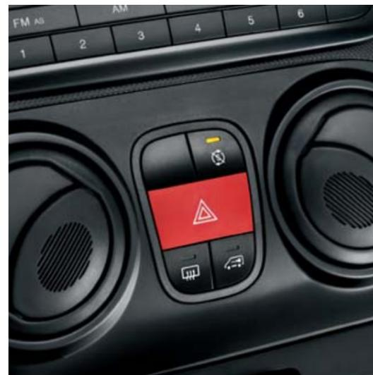
*Le système Start&Stop™ coupe le moteur pendant les arrêts de courte durée, comme par exemple à un feu rouge, et le redémarre automatiquement lorsque la pédale d'embrayage est enfoncée. Disponible en option (de série sur version 95 ch) le système Start&Stop™ permet de réduire la consommation de carburant et les émissions.*
