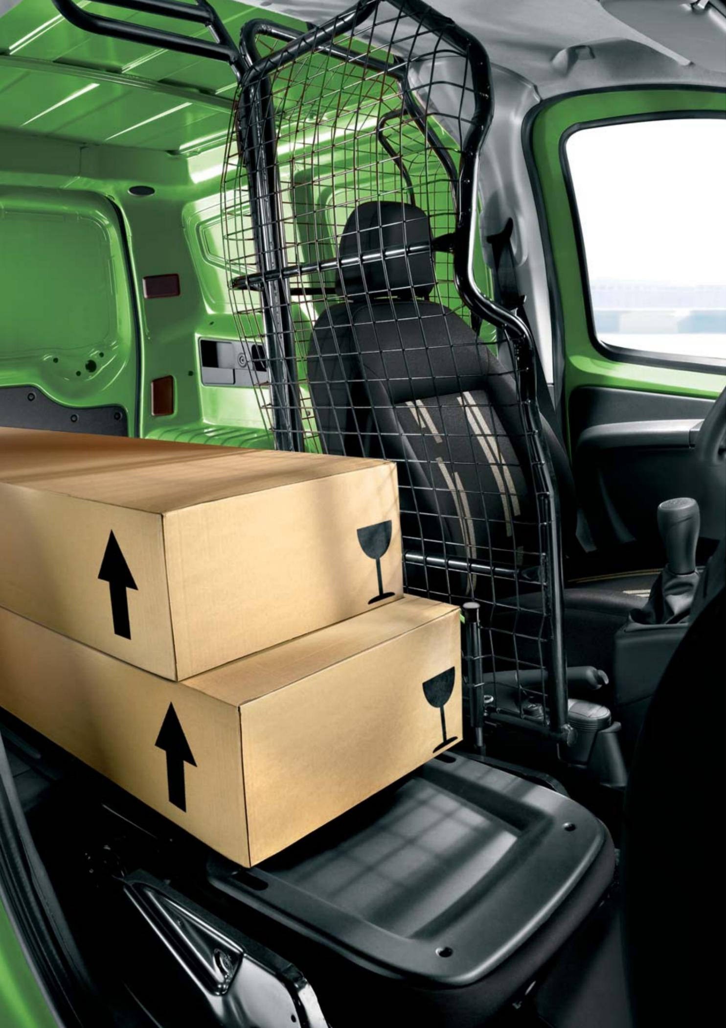
Le siège passager repliable permet d'augmenter la longueur de l'espace de chargement de presque un mètre et le volume de 0,3 m<sup>3</sup>, permettant ainsi de transporter de longs objets.
