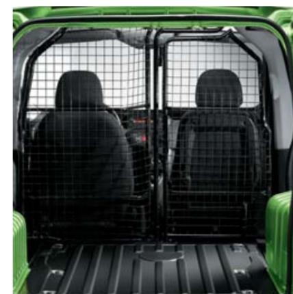
Grille de séparation en deux parties : fixe côté conducteur, pivotante côté passager avec siège repliable (en série).
