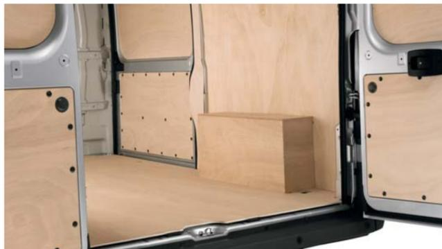
Revêtement du plancher et des parois du compartiment de chargement disponible en panneaux de bois stratifié, avec crochets de fixation du chargement.
