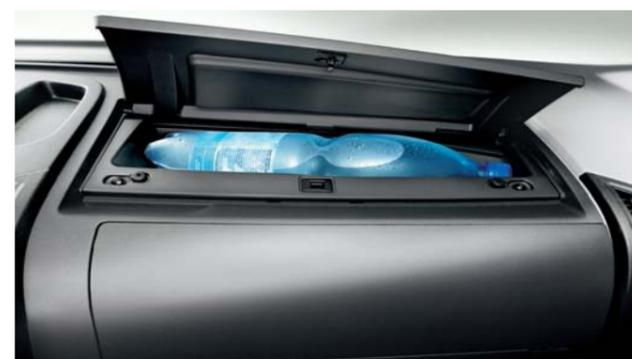
Le compartiment réfrigéré (quand la climatisation est activée) peut contenir une bouteille d'un litre et demi.
