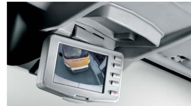
Une caméra située au-dessus de la porte arrière transmet à un écran, dans la cabine, l'image de la zone située juste derrière le véhicule, permettant ainsi d'effectuer des manœuvres en marche arrière en toute sécurité.
