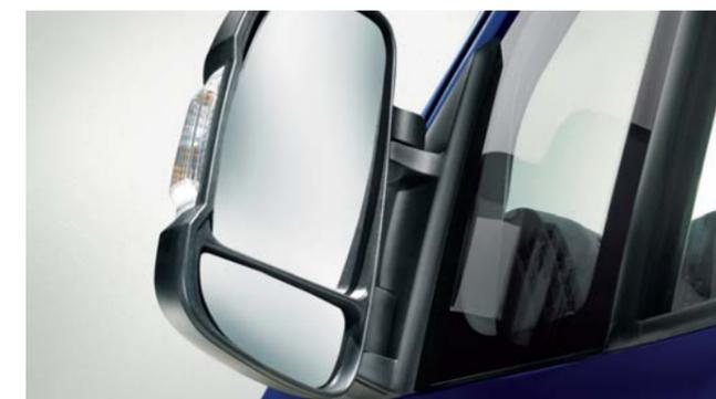
Les clignotants sont intégrés aux rétroviseurs. La partie réfléchissante est à double parabole pour améliorer la visibilité.
