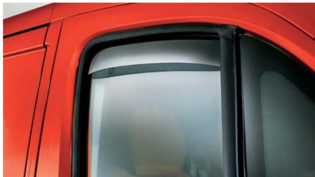
Les déflecteurs anti-turbulences permettent de voyager avec les vitres partiellement baissées même en cas de pluie et éliminent les courants d'air dans la cabine.
