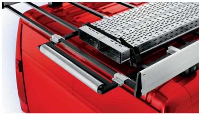
Grâce au rouleau de chargement, charger des marchandises ou des équipements sur le toit du Ducato est devenu facile : ils peuvent être fixés sur le porte-bagages grâce à des fixations appropriées.
