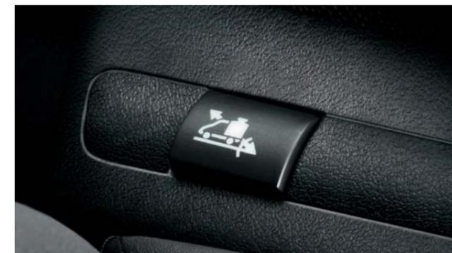
Bouton de la fonction Up situé sur le tableau de bord pour optimiser le changement de vitesse à pleine charge.
